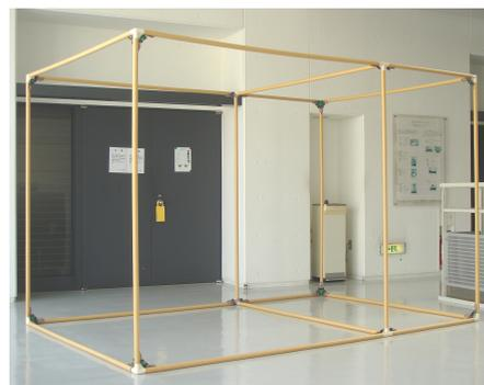
Fig. 11 本研究で作成した励磁コイル(直方体形状)
