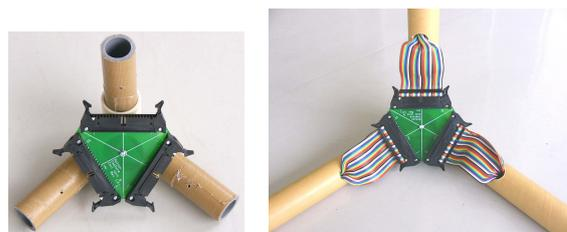
Fig. 10 励磁コイルの頂点となるジョイント部分．コイル(紙管)をさすと直交に連結される
