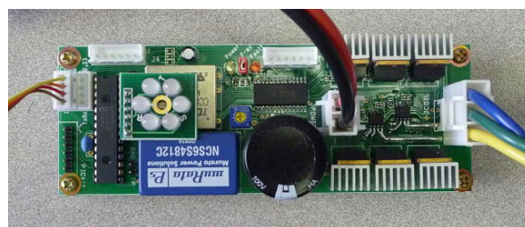
Fig. 14 開発した三相モータドライバ . 左がマイコン dsPIC33, 中央部にゲートドライバ, 右が三相ブリッジ . ブリッジの FET 間に見える IC は電流センサ .
