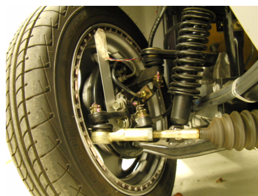
Fig. 4 前輪に取り付けた磁気式エンコーダ．
