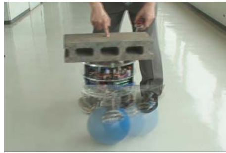
(a) ロボットにコンクリートブロックを載せ，指で動かす．
