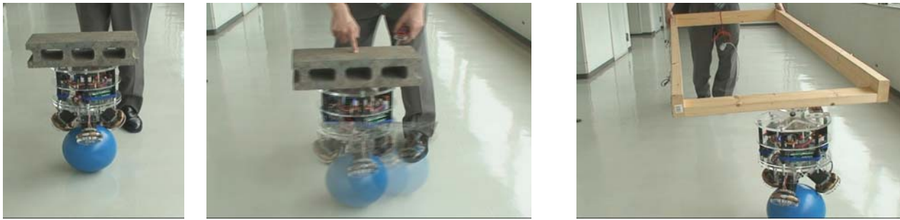
(a) ロボットにコンクリートブロックを載せ、指で動かす。
