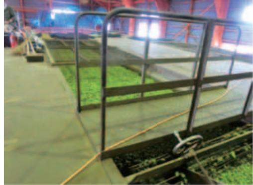
写真4 選別後のホップを乾燥機で乾燥させる
