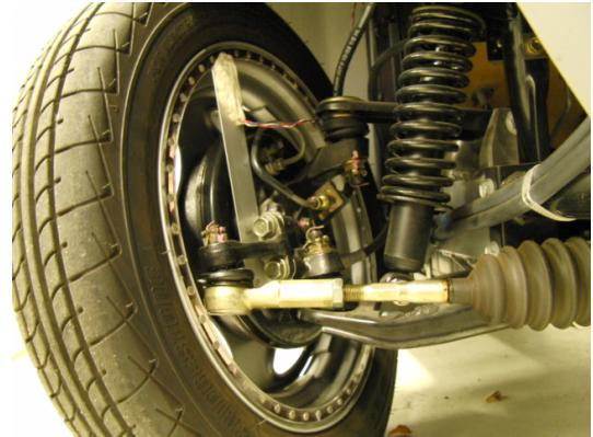
Fig. 4 前輪に取り付けた磁気式エンコーダ。
