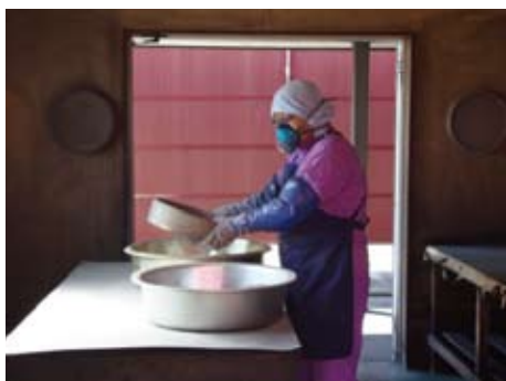
写真2 火薬の配合作業 (資料：前掲写真1)
